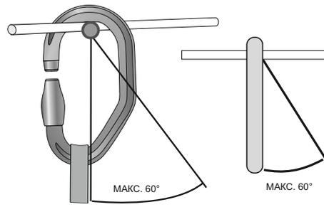
Рис. 6. Допустимый угол отклонения карабина при нагрузке
